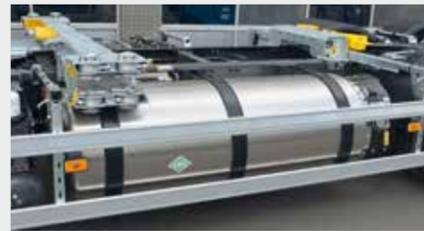
**Klappbarer Seitenanfahrtschutz** für Zugang zum Einfüllstutzen
