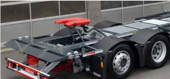
HYDRALIFTER 568 KSEG mit Sattelkupplung und Tiefkupplung nach EG-Norm.
