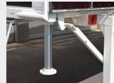
Integrierte Hubzylinder mit 100 mm Durchmesser
