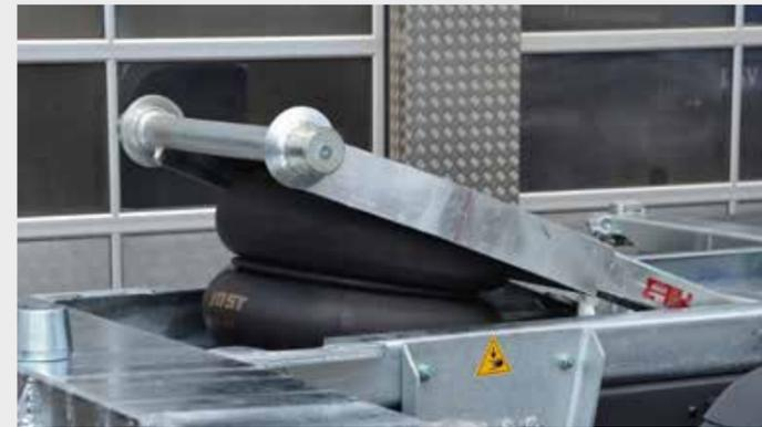
Hubschwinge mit 8 t Hubkraft, verzinkt
