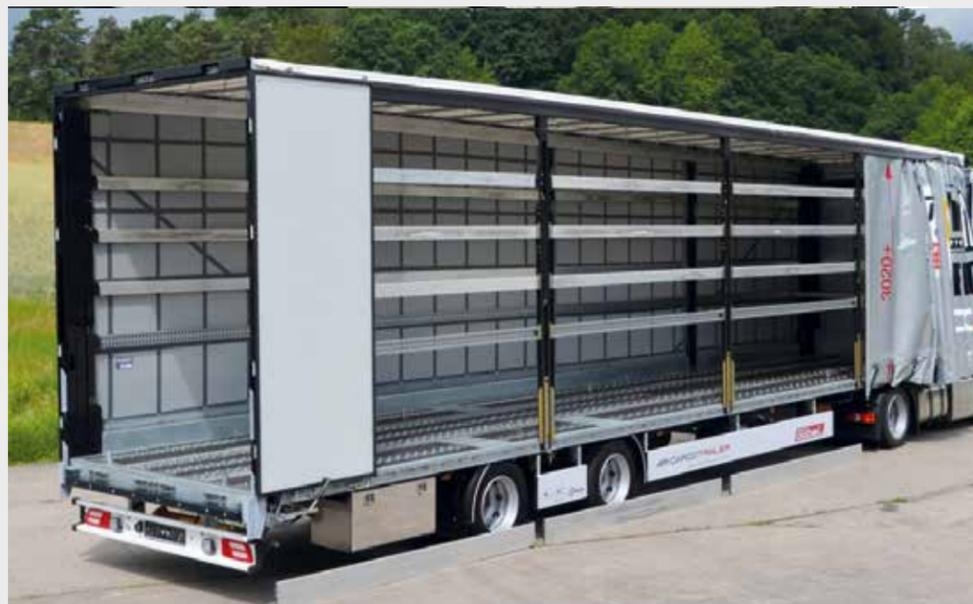
Göbel bietet Ihnen erstmals einen Auflieger für den Luffrachttransport an. Als Curtainsider-Ausführung statten wir unseren AIR-CARGOTRAILER mit allen notwendigen Zusatzeinbauten aus. Z. B. extrem flache Rollbahnen, verstärkter Stirnwand, Heck-
