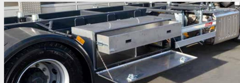
Werkzeugkasten aus Aluminium mit Schublade
