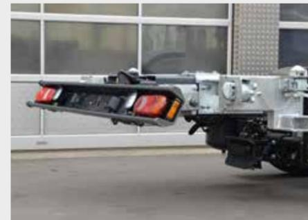
Verstellbarer Unterfahrschutz mit Tiefkupplung
