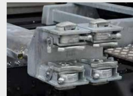
Drehbare Doppeladapter 7.45/7.82-Behälter
