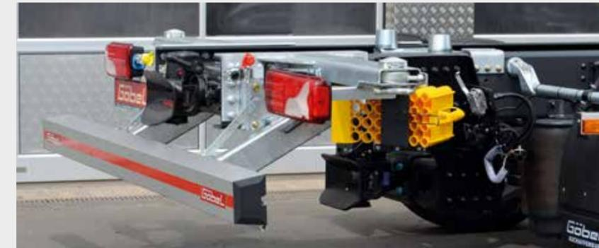
Tiefkupplung mit verstellbarem Unterfahrerschutz
