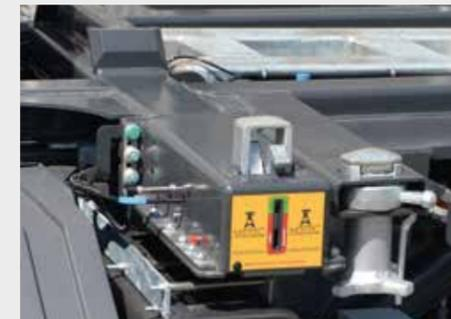
fernbedienbares Schnellverriegelungssystem MOTOC
