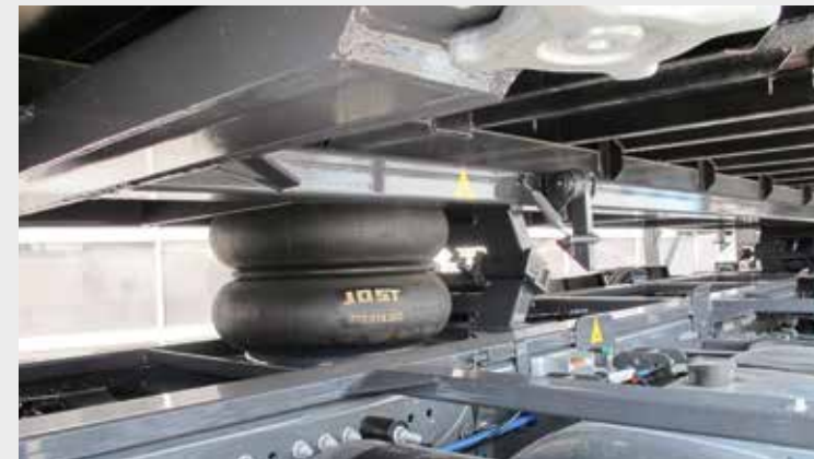
Hubschwinde mit 8 t Hubkraft
