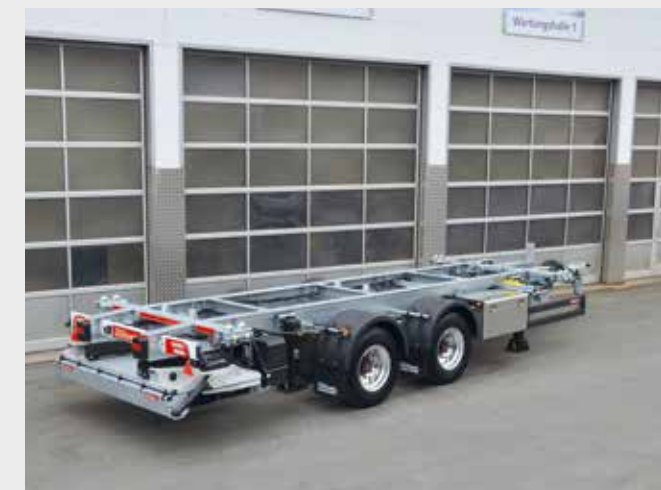
Tandemanhängers verzinkt mit Labo mit Kupplung oben
