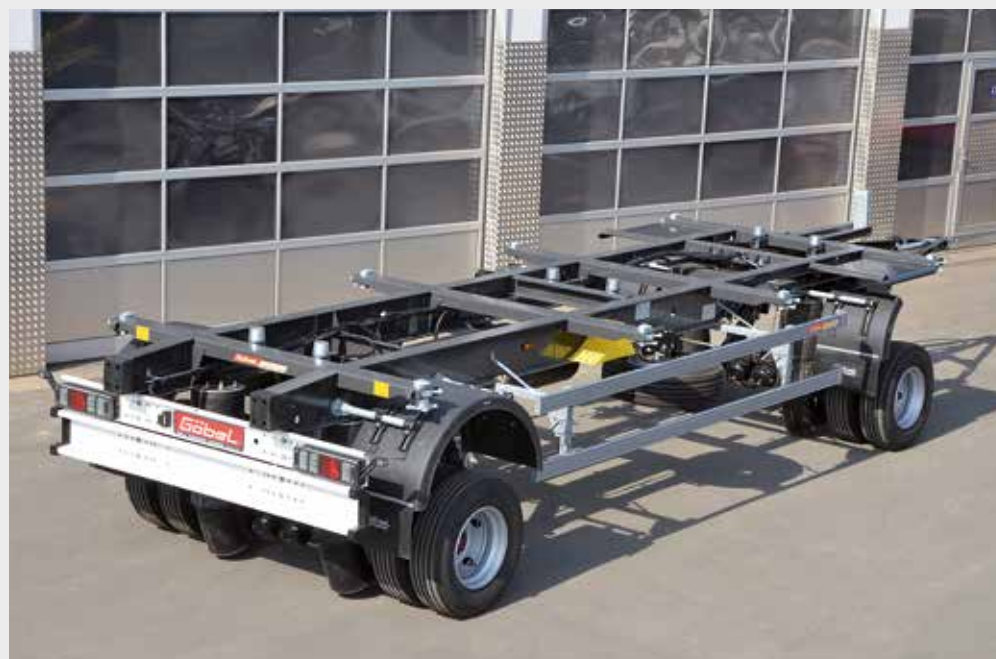
gekröpfte Spezialzugdeichsel für Ladebordwand geeignet
