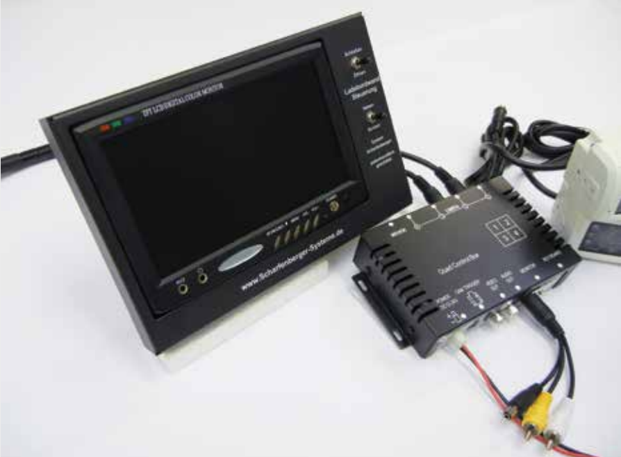
Kamerasystem mit Monitor für Ladebordwand. Laut Kundenaussage 60% weniger Schäden.
