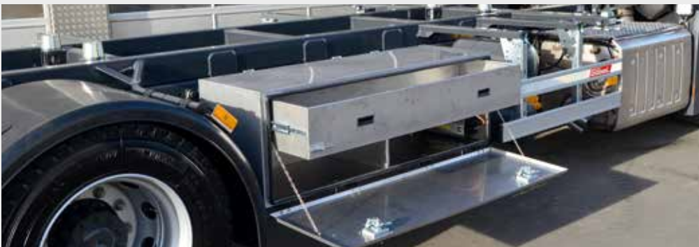
Werkzeugkasten aus Aluminium mit Schublade
