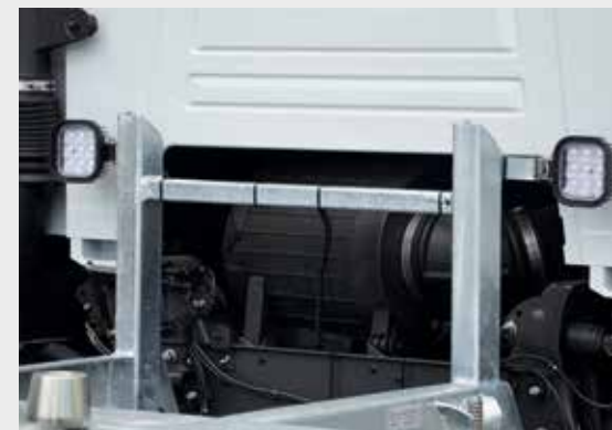
Doppelter Anschlag mit LED-Beleuchtung
