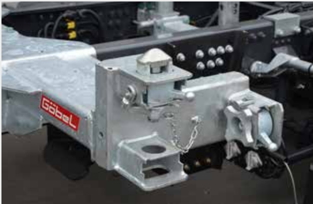
Vordere Liftadapter in tiefster Position
