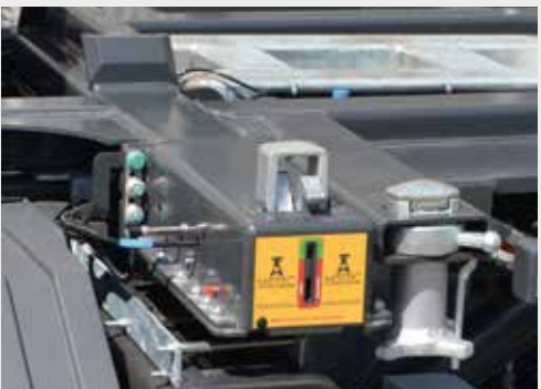
fernbedienbares Schnellverriegelungssystem MOTOC
