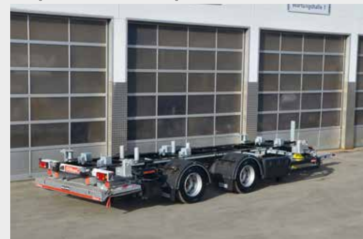
Tandemanhängers KTL mit Labo und Adapter, tiefgekuppelt
