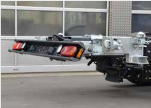
Verstellbarer Unterfahrschutz mit Tiefkupplung
