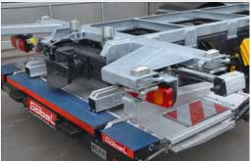
Doppelter Twistlock für 20 ft-Container, heckseitig
