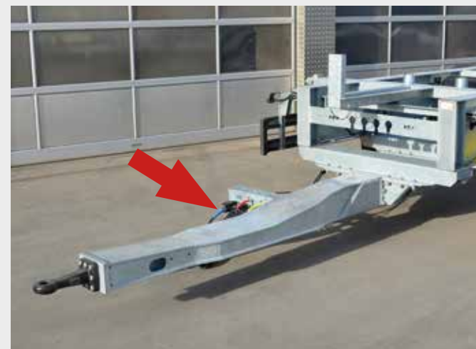
gekröpfte Spezialzugdeichsel für Ladebordwand geeignet
