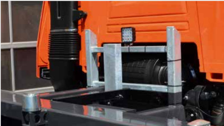
umklappbarer Zusatzanschlag für C7.45 WB
