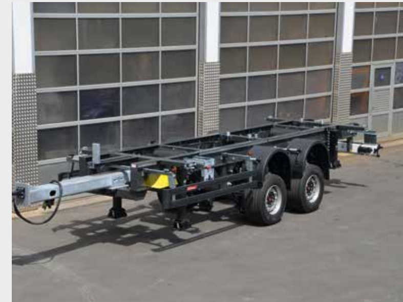
Zentralrohr für obere Kupplung
