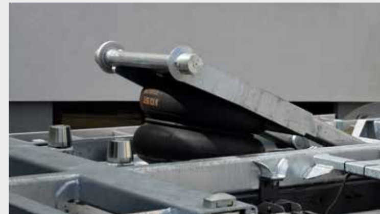
Hubschwinge mit 8 t Hubkraft, verzinkt
