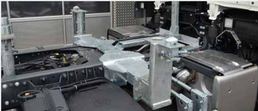
Drehadapter in höchster Position für Abstellhöhen bis 1.320 mm
