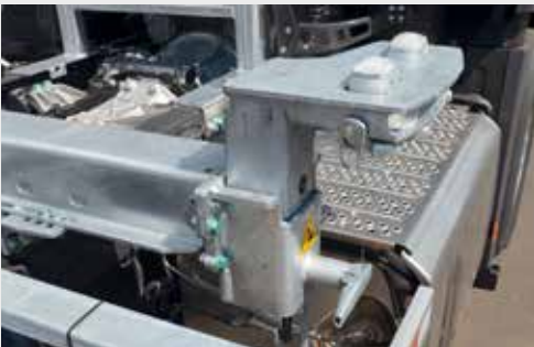
Liftadapter mit Gasdruckfeder
