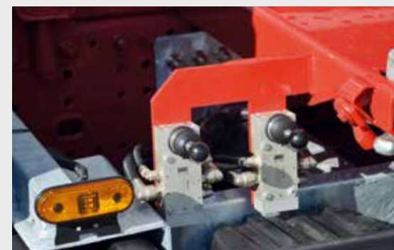
Göbel-Handhebelsteuerung mit UVV-Sicherung
