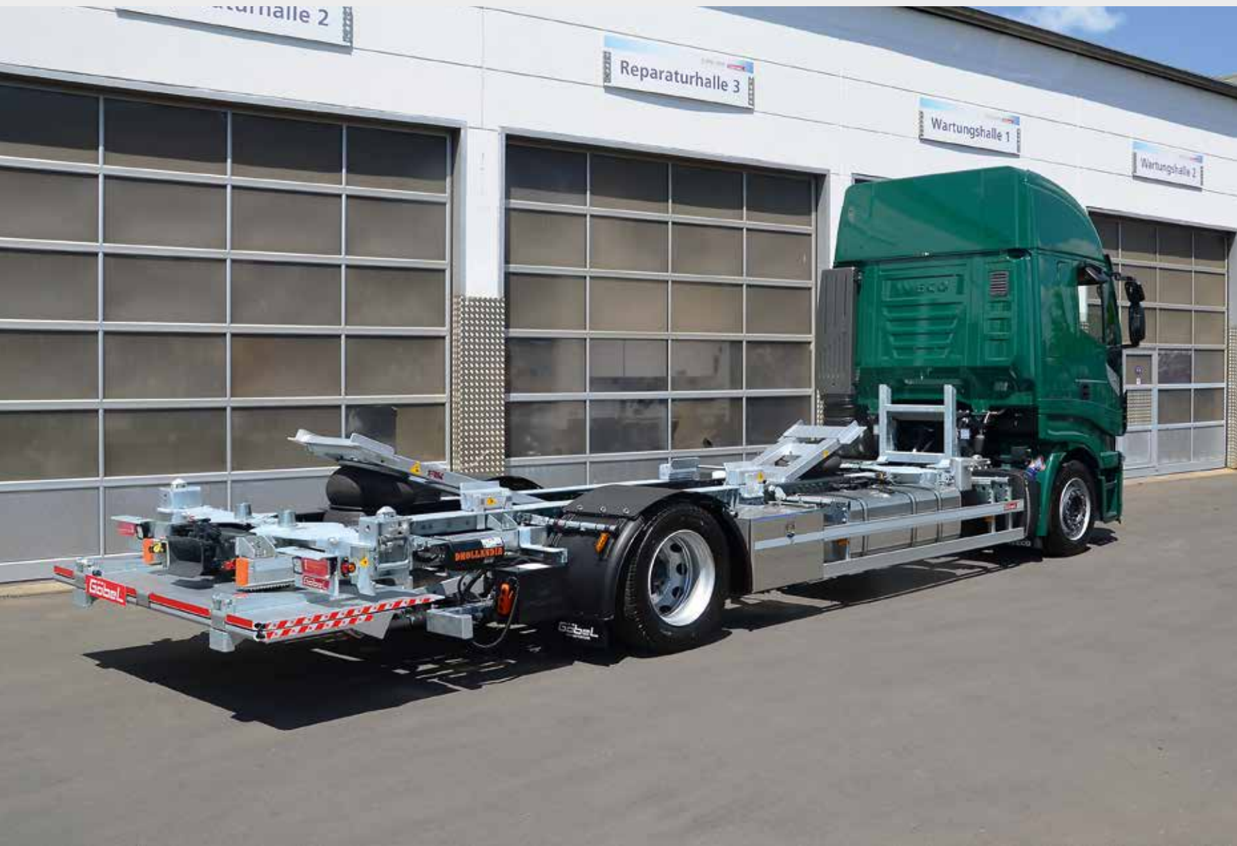
Kombinierter HUB- UND MECHANIKLIFTER mit Ladebordwand
