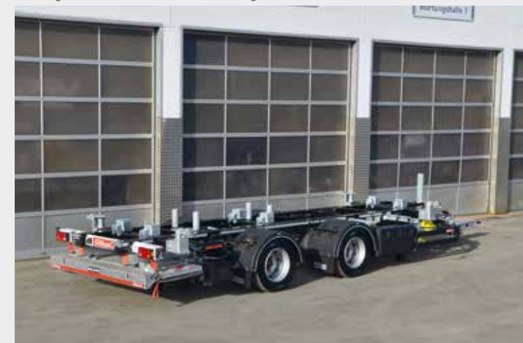
Tandemanhängers KTL mit Labo und Adapter, tiefgekuppelt
