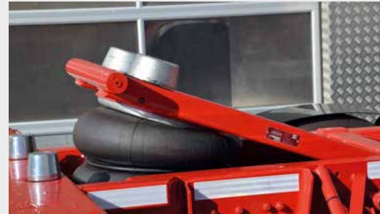
Hubschwinge mit 8 t Hubkraft
