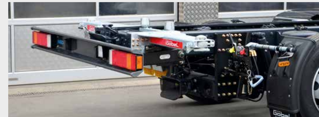
Tiefkupplung mit verstellbarem Unterfahrerschutz
