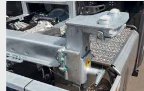
Liftadapter mit Gasdruckfeder
