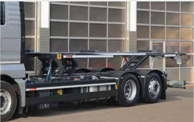
HYDRALIFTER 568 KEG mit Motoc-Schnellverriegelung
