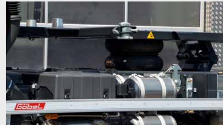
Hubschwinde mit 8 t Hubkraft
