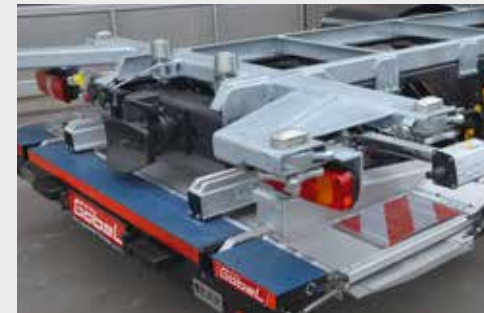
Doppelter Twistlock für 20 ft-Container, heckseitig
