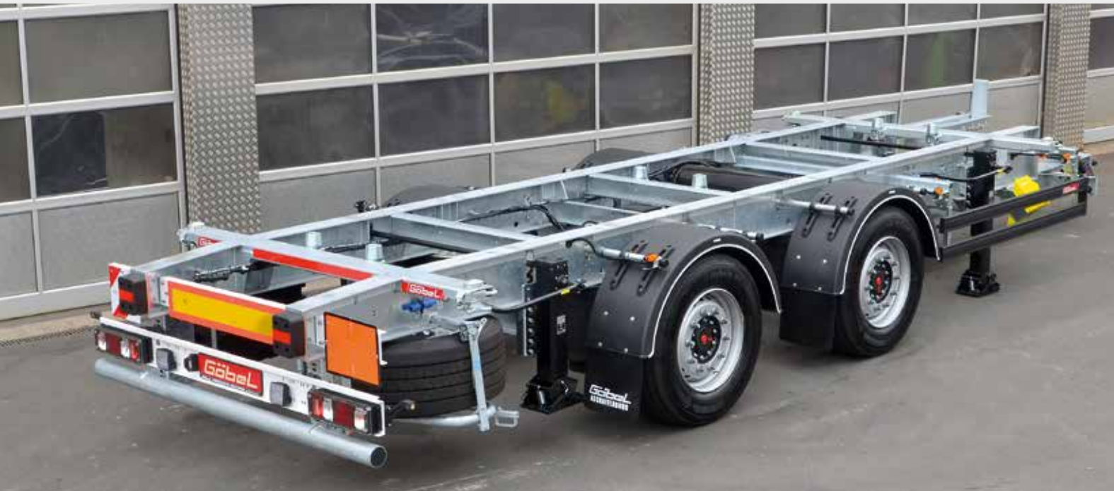
Standardzentralachsanhänger 1.120 - 1.320 mm, 385/55 R22.5, C7.45 - C7.82
