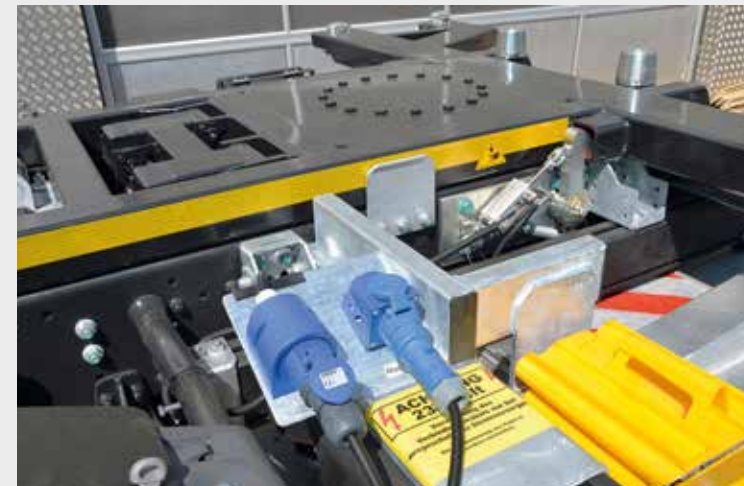
Stromversorgung für WB
