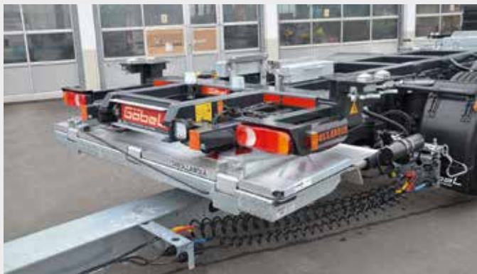
MECHANIKLIFTER 560 LiLT von 1.020 bis 1.320 mm
