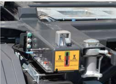
fernbedienbares Schnellverriegelungssystem MOTOC
