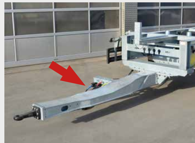
gekröpfte Spezialzugdeichsel für Ladebordwand geeignet
