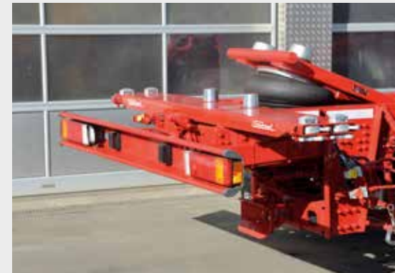
Tiefkupplung mit verstellbaren Unterfahrschutz
