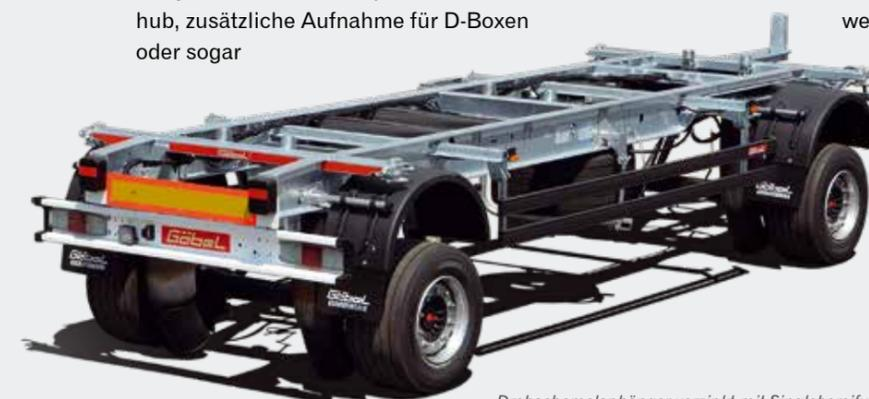
Drehschemelanhänger verzinkt mit Singlebereifung 19.5 und Hochhub
