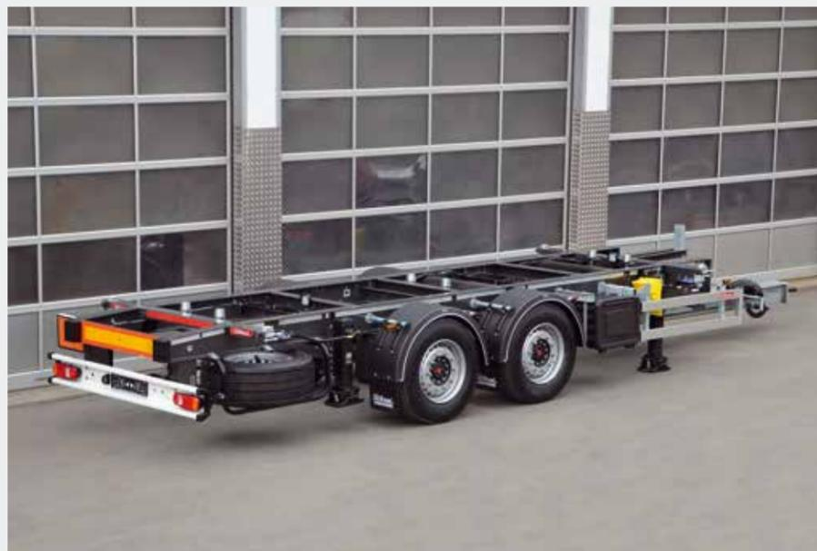
Tandemanhänger lackiert mit Hochhub, Singlebereifung 22.5 für Tiefkupplung
