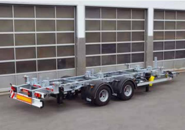
Tandemanhänger verzinkt mit Zw.-bereifung 17.5 und Liftadapter
