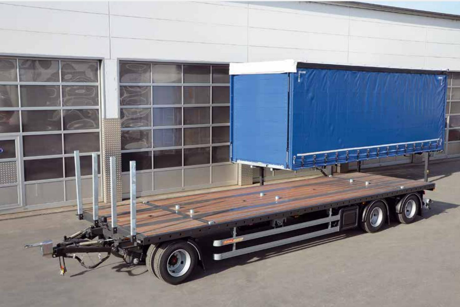
3-achsiger Drehschemelanhängers mit Holzboden und Wechselpritsche
