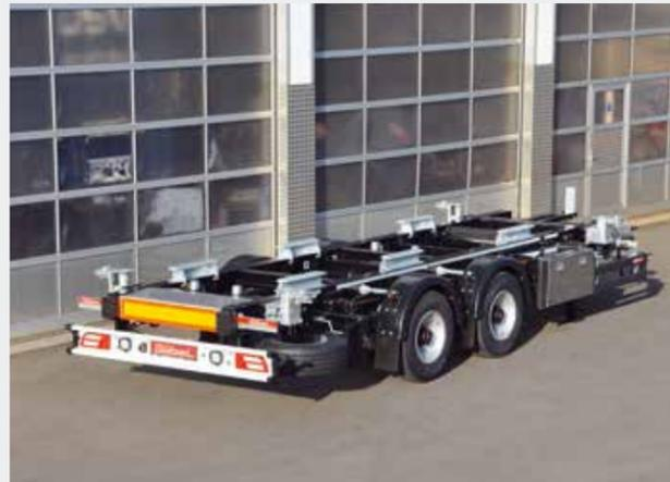
Tandemanhänger lackiert mit Singlebereifung 19.5 und Liftadapter
