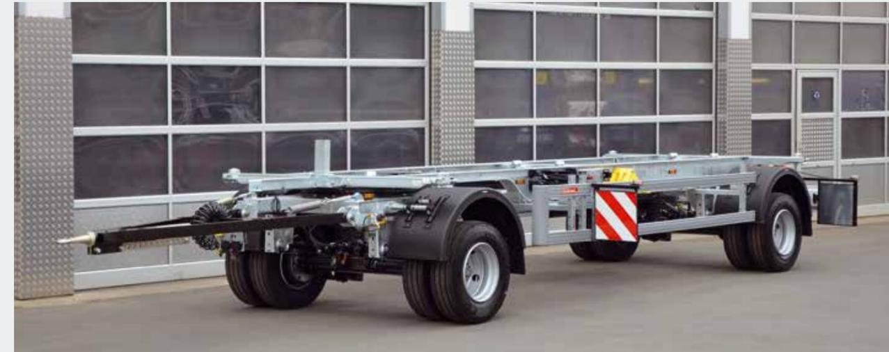
Drehchemelanhänger verzinkt mit Zwillingsbereifung 17.5 und ausziehbaren Warntafeln für Überbreite
