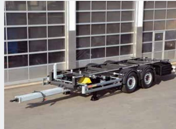
Tandemanhänger lackiert mit Singlebereifung 22.5 für Tiefkupplung
