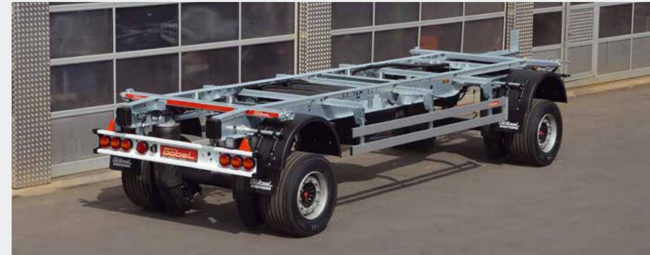
Drehschemelanhänger mit Singlebereifung 19.5 verzinkt und Hochhub
