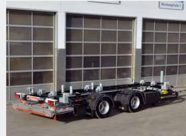
Tandemanhänger KTL-beschichtet mit Labo und Liftadapter, tiefgekuppelt
