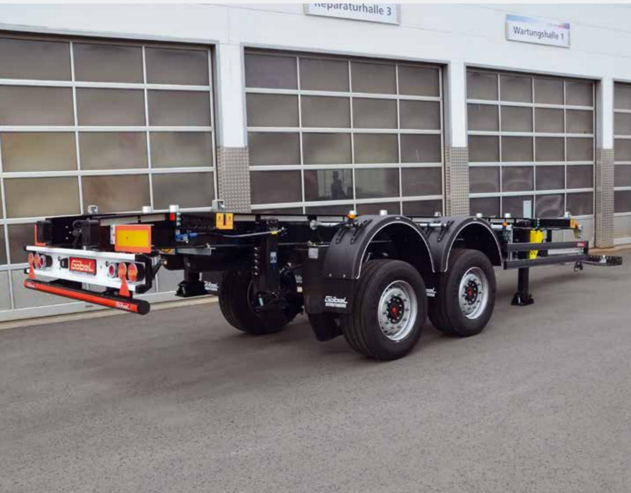
Tandemanhänger lackiert mit Hochhub und MOTOC Schnellverriegelung, Singlebereifung 22.5
