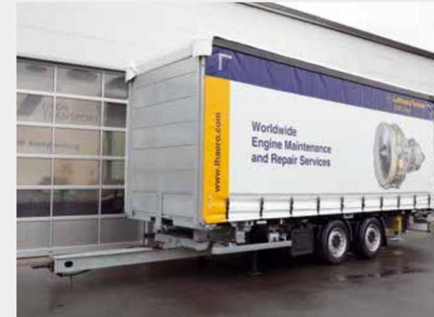
Tandemanhänger mit Curtainsider-Wechselbrücke
