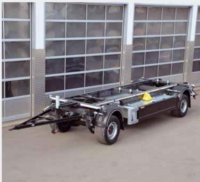
Drehchemelanhänger mit Singlebereifung 19.5 und großem Staukasten
