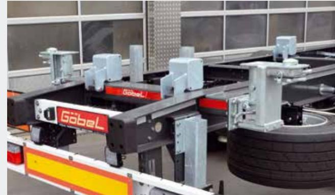
Liftadapter mit 200 mm mehr Aufnahmehöhe
