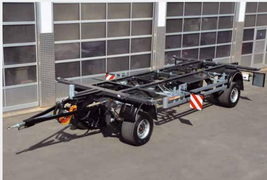
Drehschemelanhänger für Überbreite mit Singlebereifung 19.5 und Hochhub
