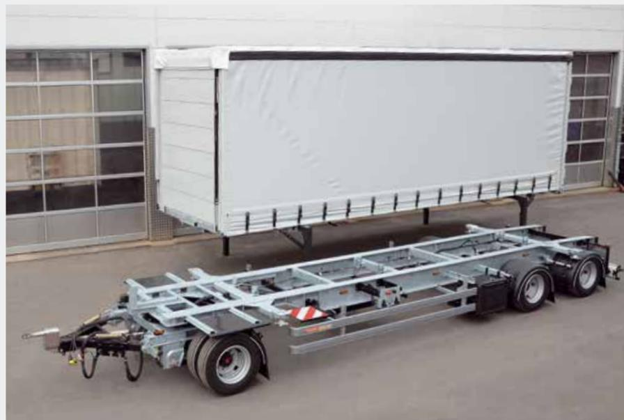
3-achsiger Drehschemelanhängers, verzinkt und C7.82er Wechselbrücke mit Curtainsider
