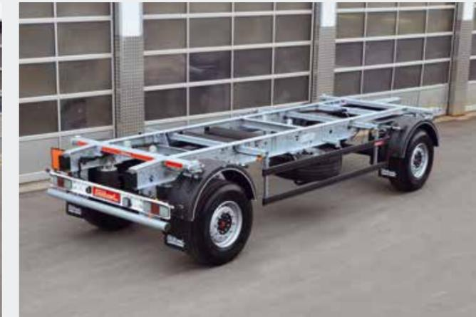
Drehschemelanhänger mit Singlebereifung 22.5, verzinkt
