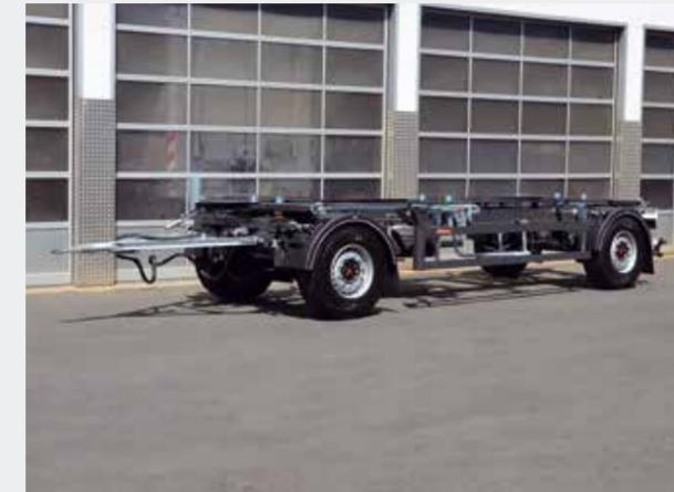
Drehschemelanhänger mit Singlebereifung 22.5, KTL-beschichtet
