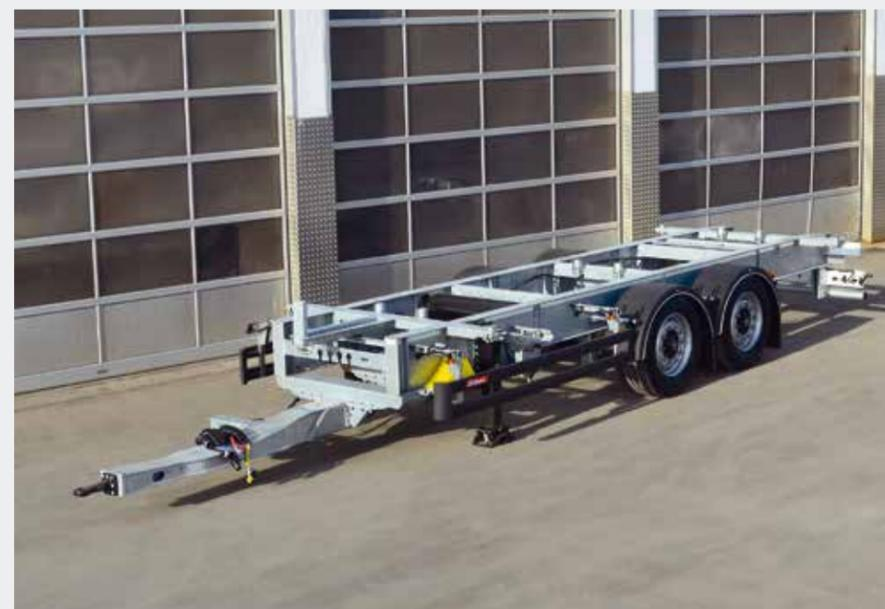
Tandemanhänger verzinkt mit Singlebereifung 22.5 sowie gekröpfter Zugdeichsel
