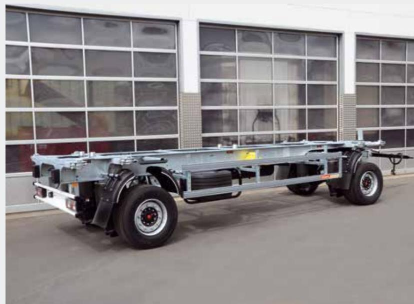
Drehchemelanhänger verzinkt mit Singlebereifung 19.5 und Hochhub sowie Doppelaufnahme
