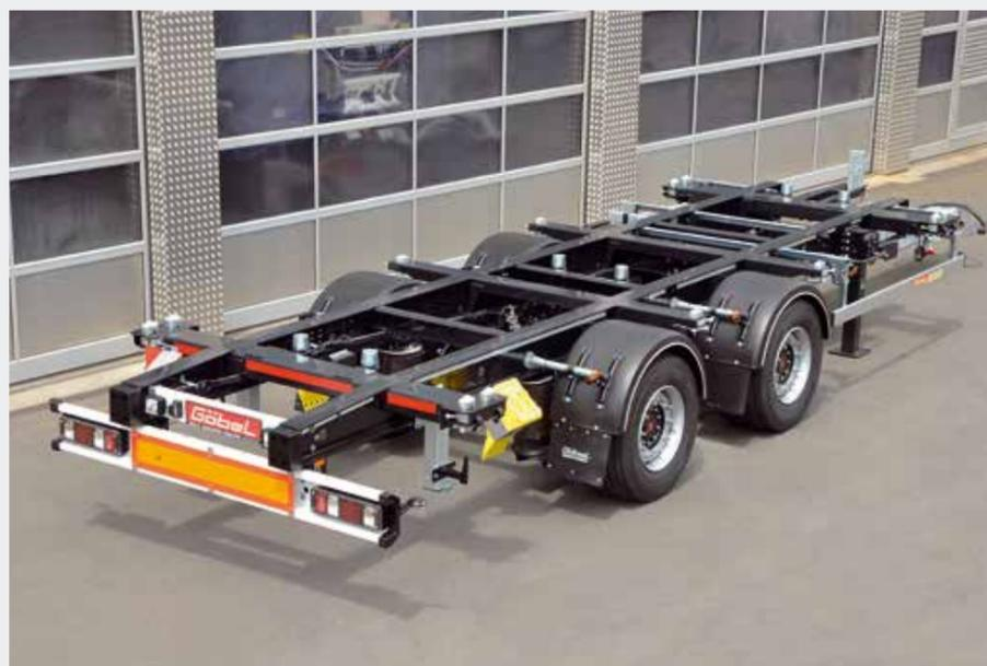
Tandemanhänger lackiert mit Singlebereifung 19.5 und WE-Größen C7.45/C7.82 sowie D-Boxen
