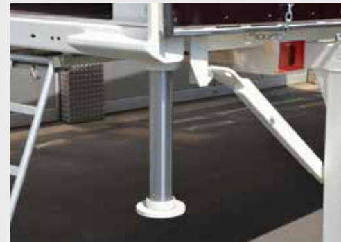
Integrierte Hubzylinder mit 100 Durchmesser
