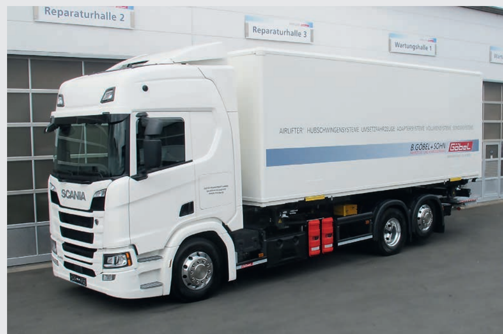
MECHANIKLIFTER 565 LiLT mit Ladebordwand und Tiefkupplung
