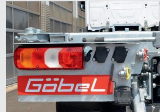
Beleuchtung und Anschlüsse in einer Einheit
