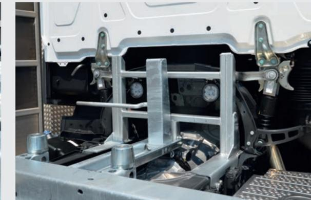
Zusätzlicher umklappbarer Anschlag für C7.45 WB
