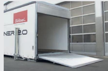
Unterbau verbaut sind. Angetrieben wird das elektrohydraulische Hubsystem über Spannungsvarianten von 24, 240 oder 400 Volt. Serienmäßig kommt die 24 Volt-Stromversorgung über einen NATO-Stecker von der Zugmaschine und wird mit einer Fernbedienung, auf Wunsch auch per Funk, angeboten.
