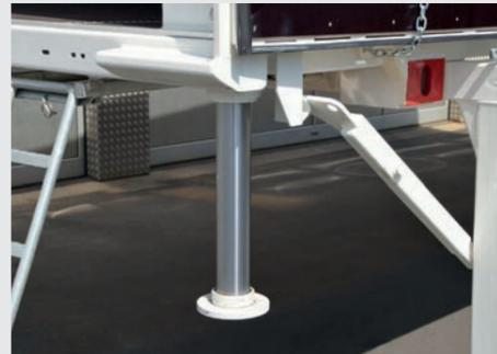
Integrierte Hubzylinder mit 100 Durchmesser
