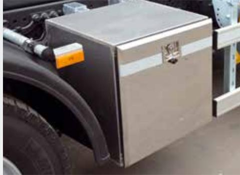
Werkzeugkasten aus Aluminium
