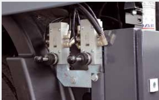
Göbel-Handhebelsteuerung mit UVV-Sicherung
