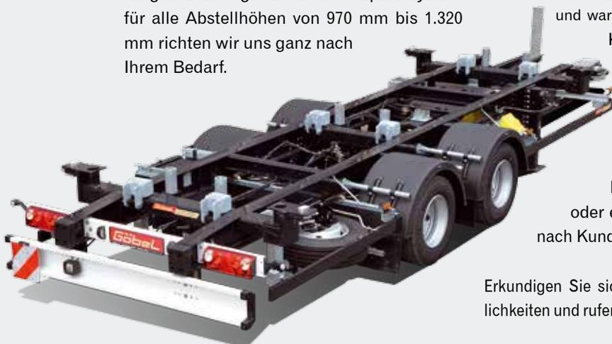
Vom Standard-BDF-Behälter bis zum Volumenbehälter sind alle Varianten der Aufnahme möglich. Die hochwertige Verarbeitung und der Einsatz von robusten und unverwüchtlichem Material garantieren einen reibungslosen und wartungsarmen Einsatz. Verzinkt, KTL-beschichtet oder in Ihrer Wunschfarbe lackiert stellen wir Ihren Anhänger mit allem notwendigen Zubehör wie z.B. Achsen, Hochhub, Bereifung, Bremsanlage, Lichtanlage oder einer speziellen Zugdeichsel nach Kundenvorgabe aus.
