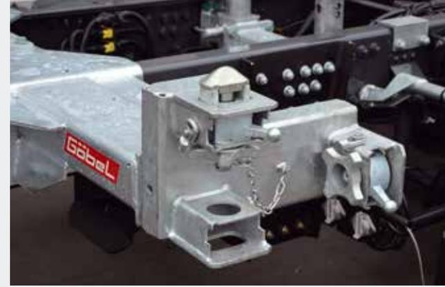
Drehadapter in mittlerer Position
