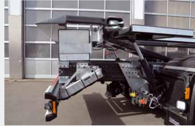
Verstellbarer Unterfahrerschutz und Tiefkupplung
