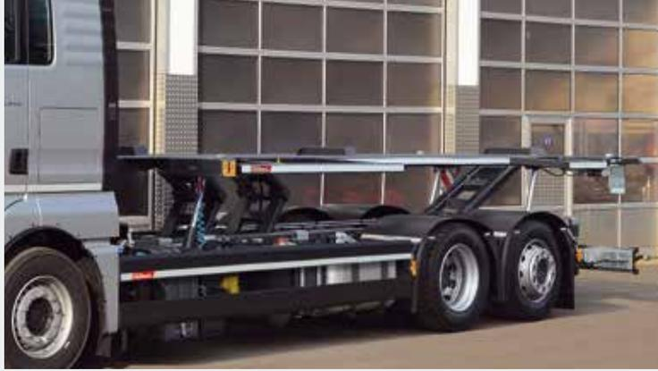
HYDRALIFTER 568 KEG mit Motoc-Schnellverriegelung
