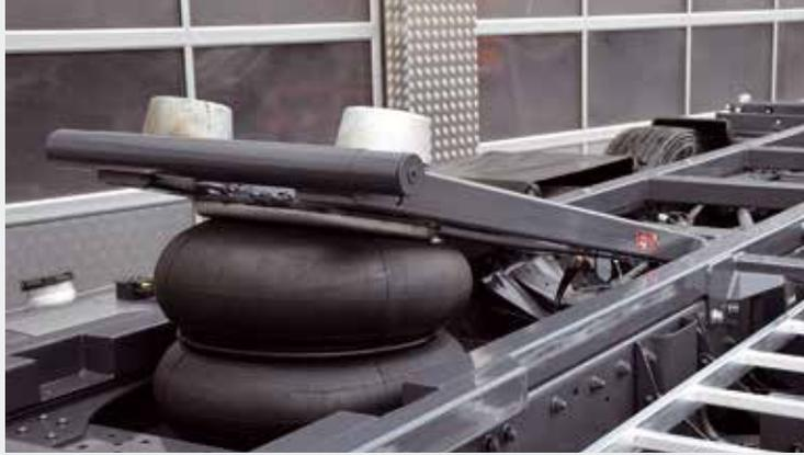
Hubschwinge mit 8 t Hubkraft
