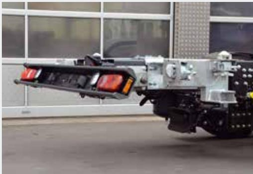
Verstellbarer Unterfahrschutz mit Tiefkupplung
