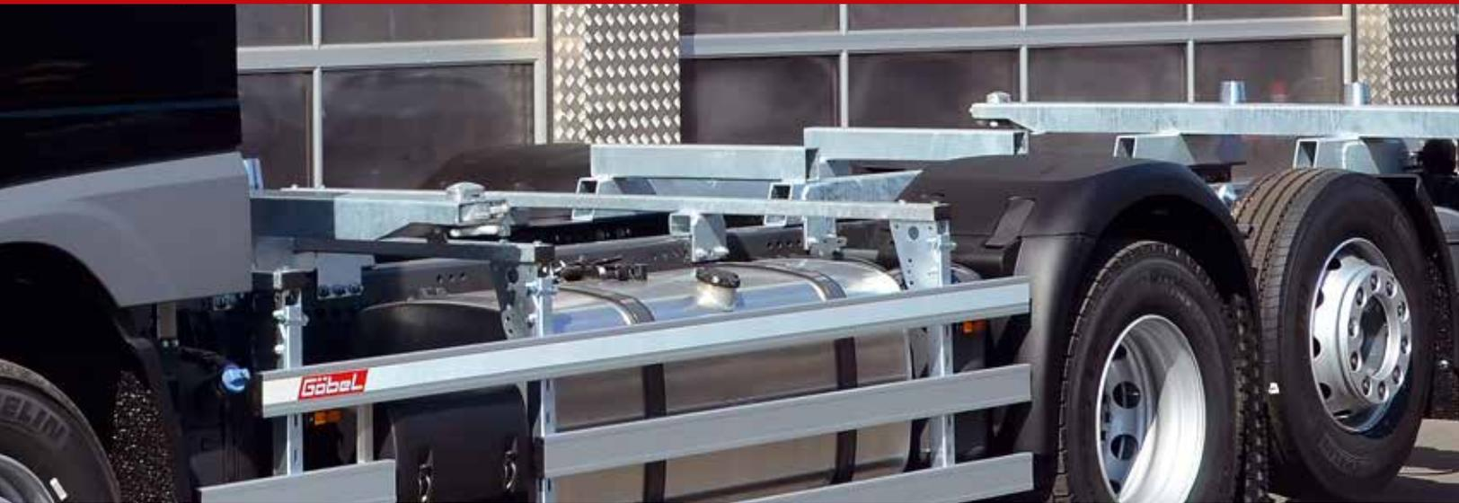
**Pneumatischer Wechselaufbau** mit einem durchgehenden stabilen Wechselrahmen, der von i.d.R. zwei vertikal mit Luft betriebenen Hubbälgen angehoben oder abgesenkt werden kann. Eine Fernbedienung vom Fahrerhaus ist serienmäßig eingebaut. Alle Abstellhöhen und Behältergrößen möglich.
