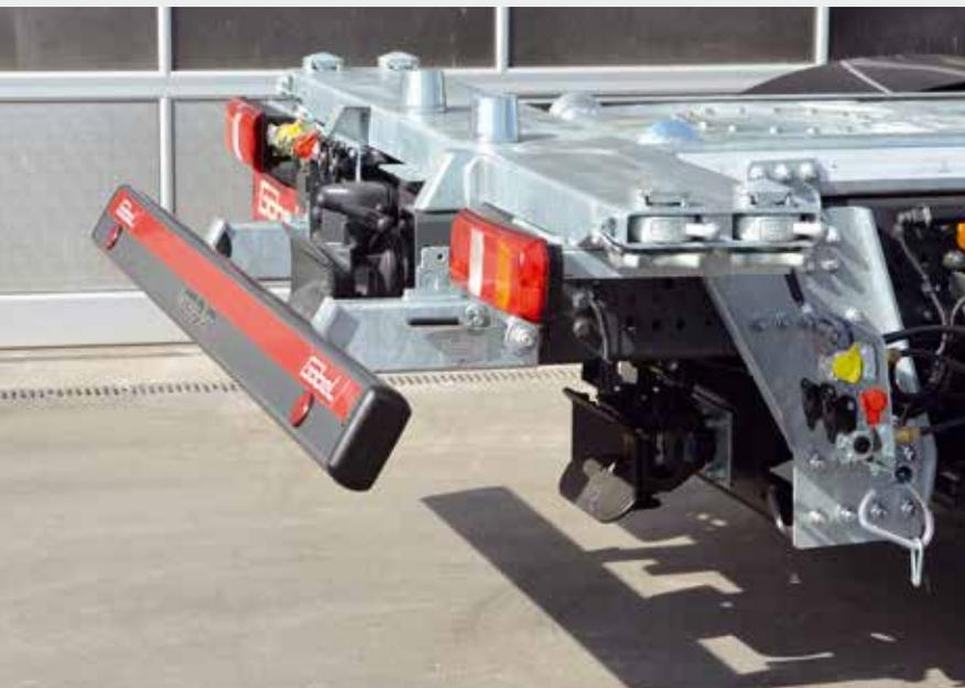
Tiefkupplung mit verstellbarem Unterfahrerschutz
