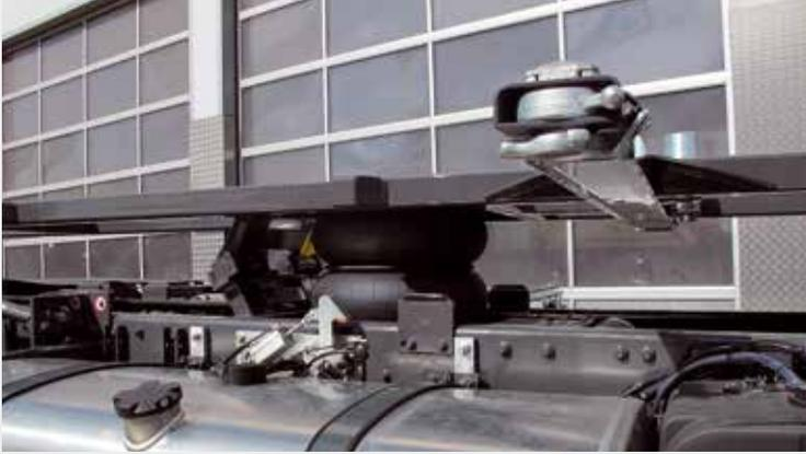
Hubschwinge mit 8 t Hubkraft
